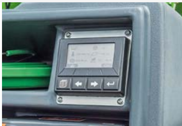
Zkouška výsevku pomocí terminálu TwinTerminal 3.0
