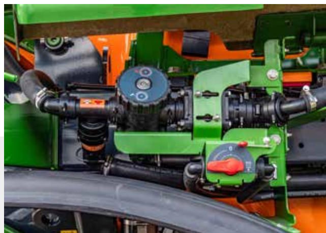
✔ Systém HighFlow + je vybavený dodatečným, samočisticím tlakovým filtrem.
