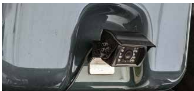
Couvací kamera v zadní části samochodu Pantera
