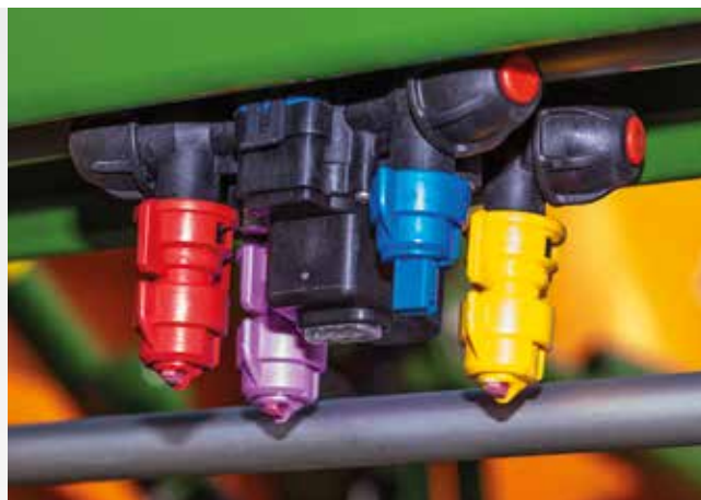
✔ Elektrické spínání jednotlivých trysek AmaSelect
