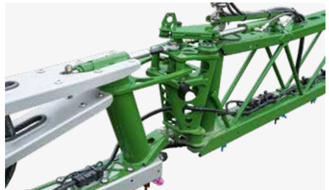
Hydraulicky ovládané jistění proti přetížení koncového ramena („princip lítačkových dveří“) umožňuje vychylování dozadu, dopředu a nahoru a současně umožňuje spolehlivé navrácení ramena do původní polohy a zachování jeho dlouhé životnosti.
