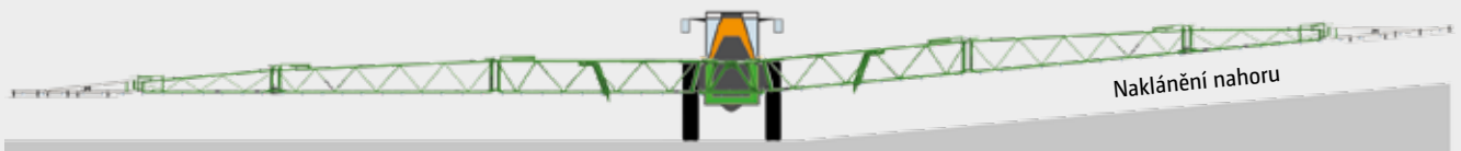
Naklání ramen nahoru (pomocí skládání Flex 2)
