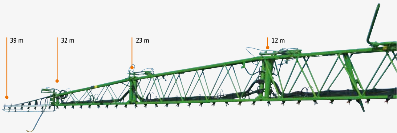
Postřikovací ramena Super-L2 39 m, s možností redukce na 32 m, 23 m a 12 m
