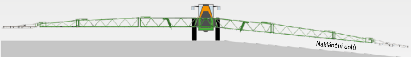
Naklání ramen dolů (pomocí skládání Flex 2 v kombinaci se systémem ContourControl)
