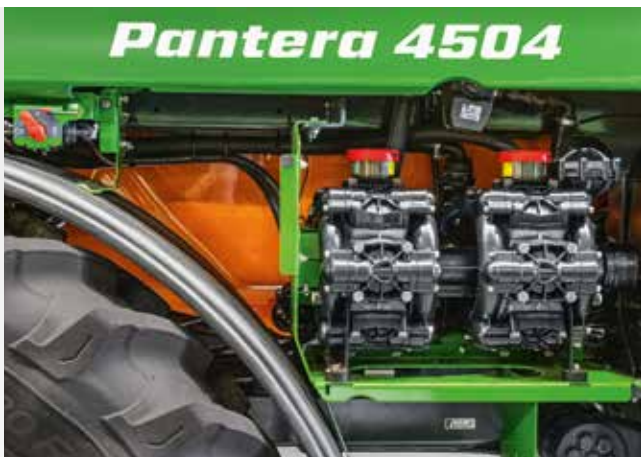
Čerpadlo na pravé straně stroje
