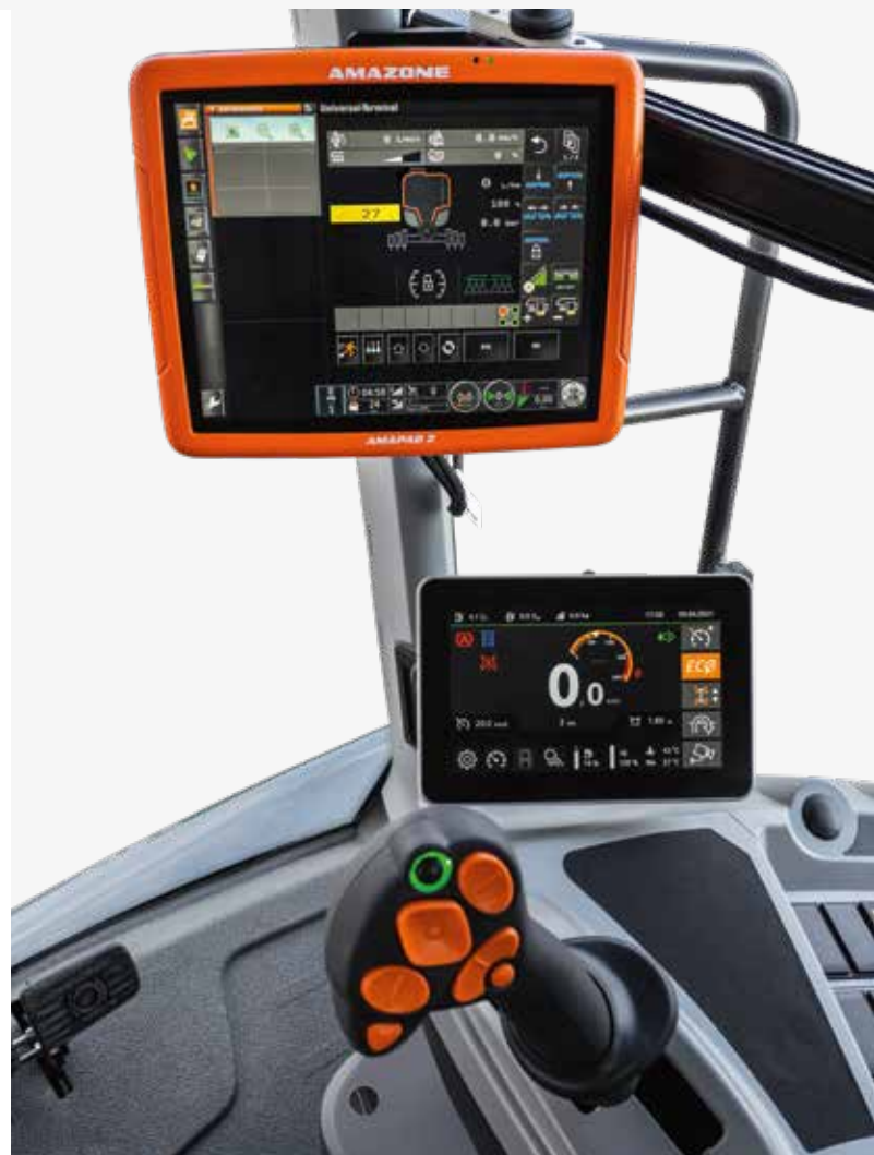
Řešení se dvěma terminály - terminál ISOBUS AmaPad 2 a terminál stroje AmaDrive 7.0 - a multifunkční joystick AmaPilot+
