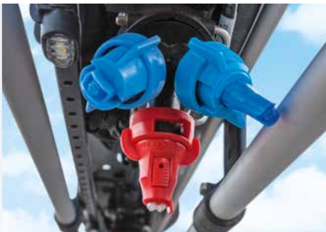
✔ Elektrické ovládání jednotlivých trysek AmaSwitch
