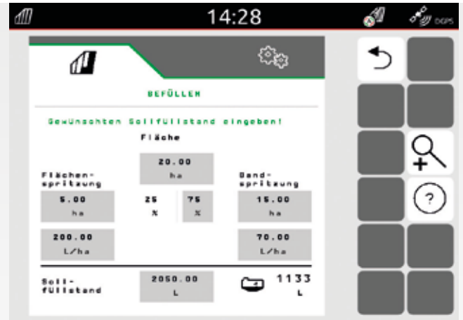
Užitečné menu plnění pro výpočet objemu jíchy
