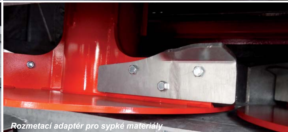
Průměr rotoru 323 mm + 62 nožů
