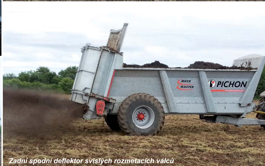
Zadní spodní deflektor svislých rozmetacích válců
