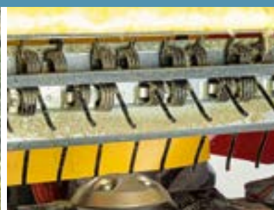
Rotor kondicionéru na stroji Fella má průměr 460 mm a je osazen 48 pružnými ocelovými prsty. Šířka rotoru je 2,23 m. Tento stroj vytváří poněkud hranatý a kompaktní řádek.
