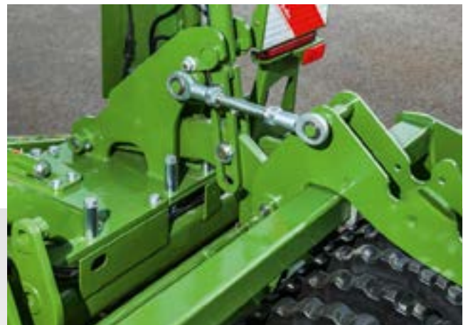
✔ Paralelní vedení válce
