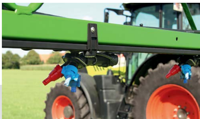
Spínání jednotlivých trysek AmaSwitch
