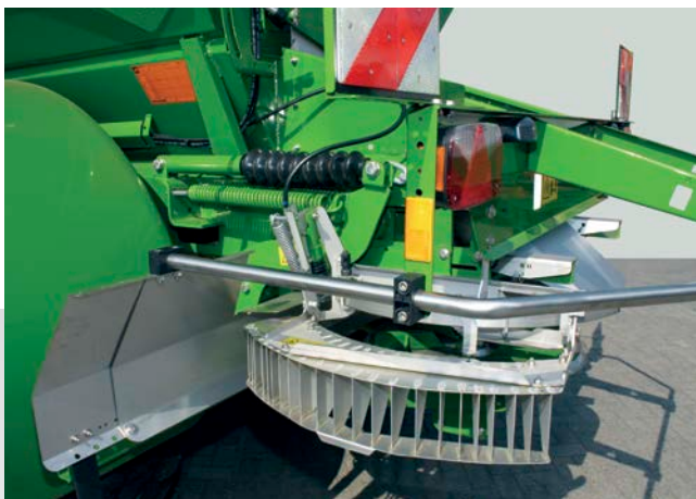
Omezovač záběru Limiter sklopený v pracovní poloze
