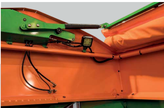
Pracovní osvětlení ve vnitřním prostoru zásobníku
