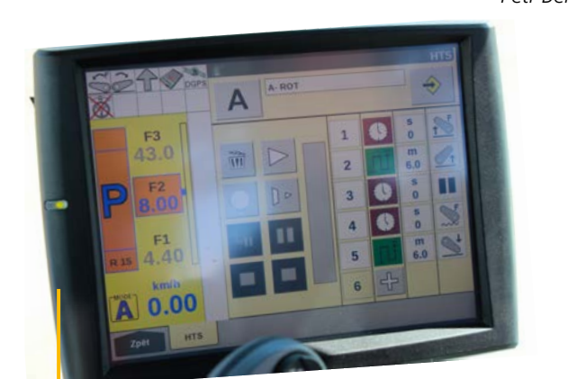
Přehledné zobrazení jednotlivých úkonů v sekvenci včetně druhu závislosti na ujeté dráze či na čase jsou výsady nového systému souvracové automatiky HTS II. Každý úkon samostatně či jeho závislost je možné upravovat, a to i u stojícího traktoru, kdy lze také všechny úkony uložit do sekvence
