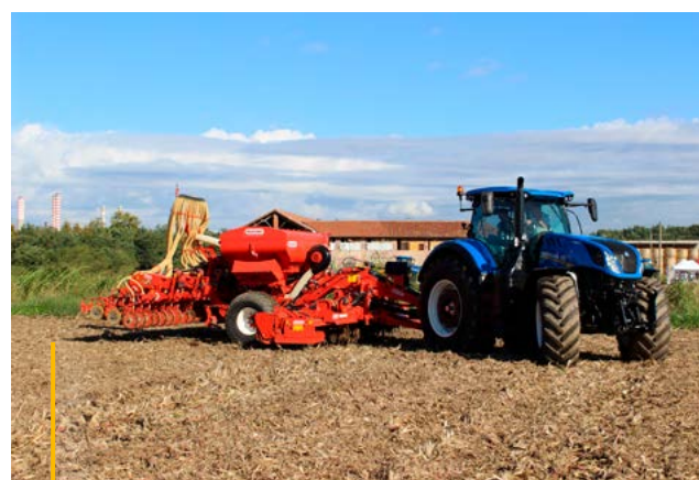
Při práci se secími kombinacemi v taženém provedení dokáže systém HTS II na shodném místě zvedat rotační brány a pak i secí lištu, a po otočení a ujetí určité dráhy opět spustit rotační brány a poté i secí lištu k zemi rovněž na shodné linii
