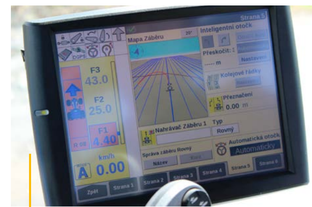
Ovládání a nastavení je integrováno v terminálu IntelliView IV. Trasu pro plánovanou automatickou otočku systém vybarví červenou barvou, která je odlišná od značení navigačních linií
