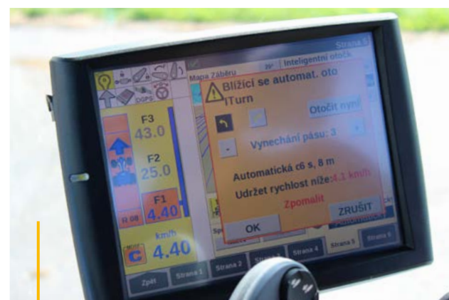
Na tomto žlutém poli informuje systém IntelliTurn obsluhu traktoru o svých záměrech. Řídič může zvolit jiný směr otáčení, pokud to je zapotřebí (tlačítko se šipkou), dále zahájit otáčení kdykoli dříve (tlačítko otočit nyní) či automatické otáčení vypnout
