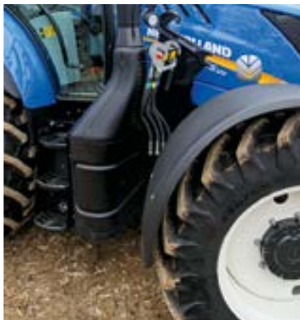
Držáky čelního nakladače je nyní možné namontovat přímo ve výrobním závodě (na přání). Jsou přizpůsobeny 1,1 m širokému nakladači Stoll. SCR je umístěné dole pod výfukovým potrubím.
