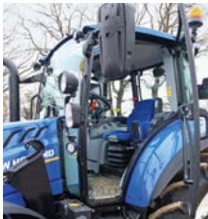
Mezi nové věci dále patří stěrač s úhlem stírání 200° a velká zrcátka. Zrcátka jsou nepohodlně umístěná nad schůdky.
