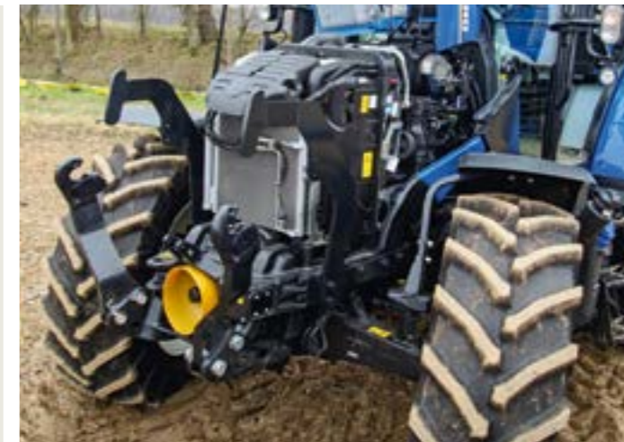
Aby čtyřválcové motory FPT s objemem 3,4 l vyhovovaly náročným požadavkům přísné emisní normy Stage IV (Tier 4 final), tak vyměnily systém DPF (filtr pevných částic) za oxidační katalyzátor DOC, který je umístěn v zadní části pod kapotou a dále za systémem odbourávání škodlivých látek SCR, který je umístěn na výfukovém porubí na pravé straně.
