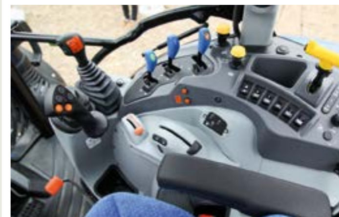
Řidič dnes může ovládat převodovku powershift a za/vypínat spojku pomocí tlačítek na novém joysticku čelního nakladače (viz obrázky vlevo).
