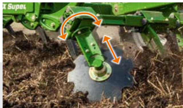
Krajní disk – samostatné nastavení výšky a úhlu
