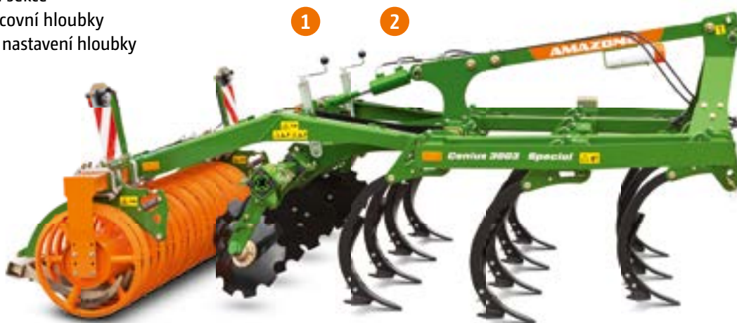
Cenius Special: Radličky C-Mix se střížnou pojistkou a prstencový válec WW
