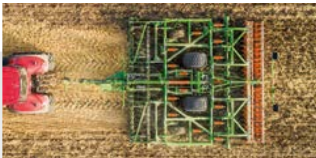
Za každým kolem se nachází radlička pro kypření stopy
