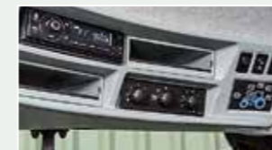
Ovládací panel pro ventilaci je umístěn ve střeše traktoru, vedle rádia.
