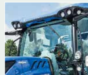
Až 12 LED diodových světel je strategicky rozmístěných kolem kabiny.
