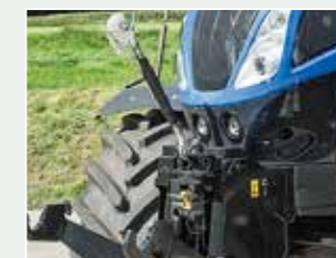
Obtížná manipulace s držákem třetího bodu; třetí bod zapadá přesně do uchycení rychlospojek.
