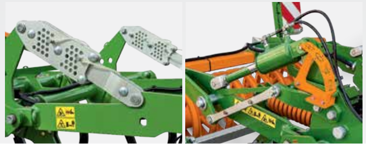
Mechanické nastavení pracovní hloubky
