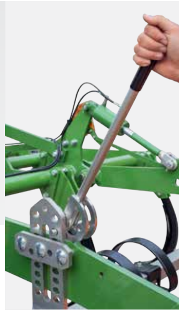
Manuální nastavení zarovnávací jednotky pomocí segmentu s otvory
