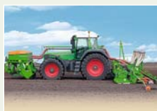
Pneumatická kombinace pro výsev do posklizňo- vých zbytků s čelním zásobníkem Avant
