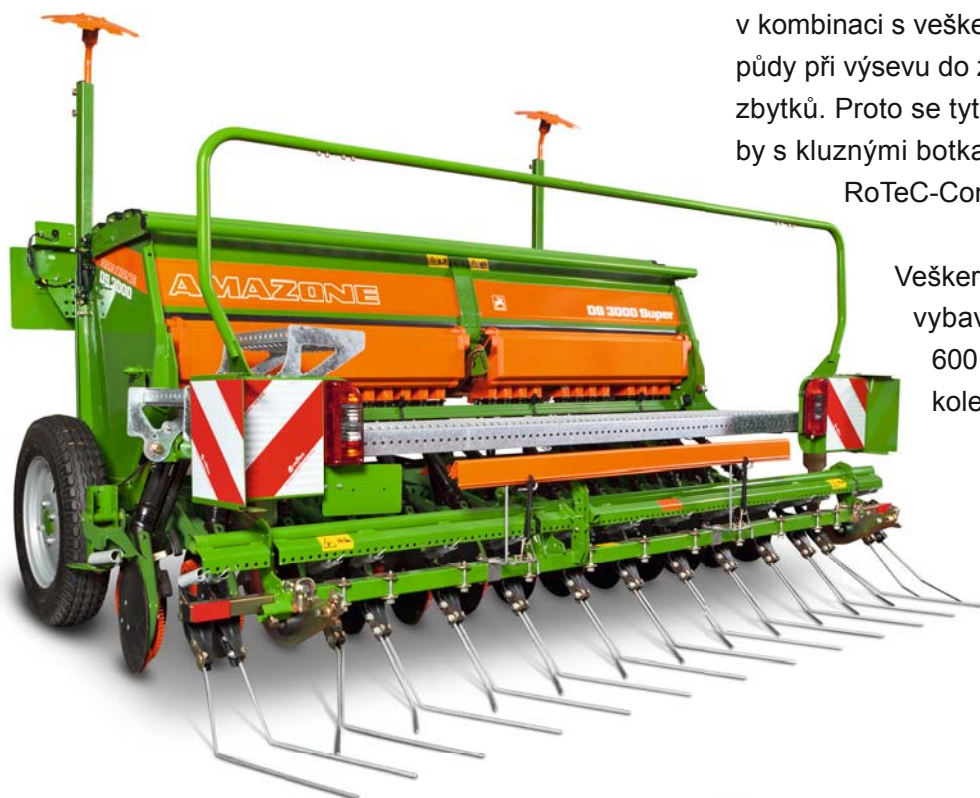
D9 3000 Super s pracovním záběrem 3 m a diskovými botkami RoTeC-Control.
