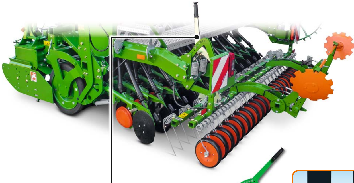
Mechanické nastavení přítlaču na zavlačovač
