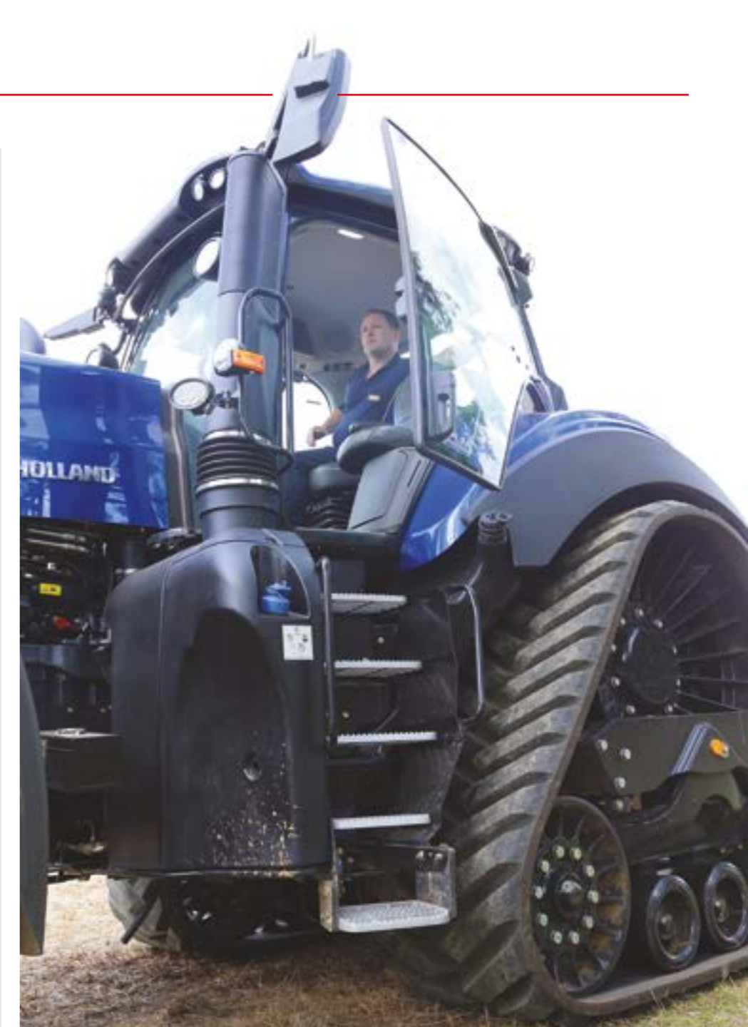
Kabina T8 má nyní čtyři sloupky. Po odstranění sloupku B se do kabiny vešly větší dveře. Díky tomu je vstup širší a uživatel má lepší výhled.
