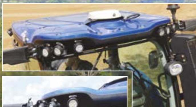
Intenzita osvětlení vzrostla o 30%, ale masivním pracovním reflektorům po obou stranách předního skla (povinné u předního TBZ) by si zasloužily lepší umístění.
