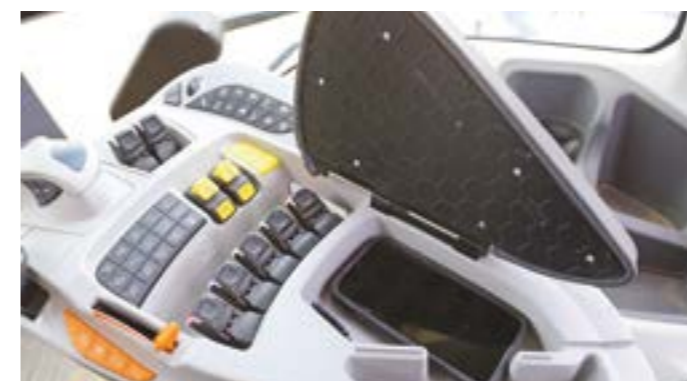
Sklopný panel nad krycí loketní opěrkou můžete posunout dopředu, takže zakrývá všechny spínače vnějších okruhů hydrauliky – jednoduché a efektivní řešení.
