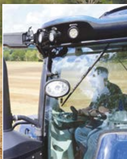
Intenzita osvětlení vzrostla o 30%, ale masivním pracovním reflektorům po obou stranách předního skla (povinné u předního TBZ) by si zasloužily lepší umístění.
