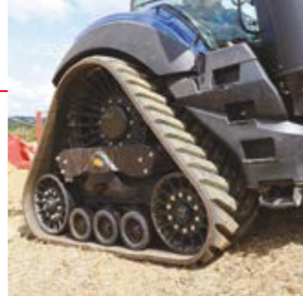
Pro pásové traktory jsou k dispozici nová hnací kola a nové pásy od společnosti Camso. Ty jsou údajně odolnější při pohybu na silnici.
