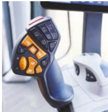
Stejně jako u předchozí generace jsou ovladače motoru a převodovky oranžové. Traktor nabízí prostor pro mnohem více individuálních nastavení hydraulických funkcí.
