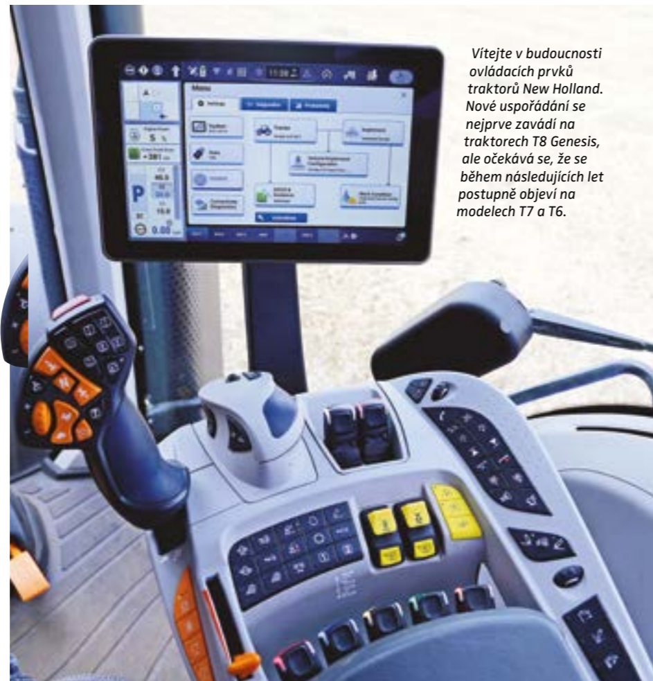
Stejně jako u předchozí generace jsou ovladače motoru a převodovky oranžové. Traktor nabízí prostor pro mnohem více individuálních nastavení hydraulických funkcí.
