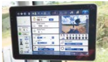
Kamera namontovaná na přední mřížce je darem z nebes, když potřebujete vyjet na silnici. Výstup z kamery se zobrazí na hlavním displeji a druhá kamera hlídá zadní stranu traktoru.
