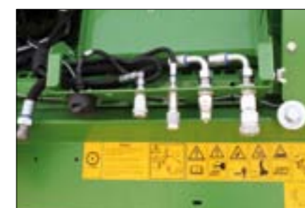
Bez použití nářadí Rychlospojky hydraulických přípojek
